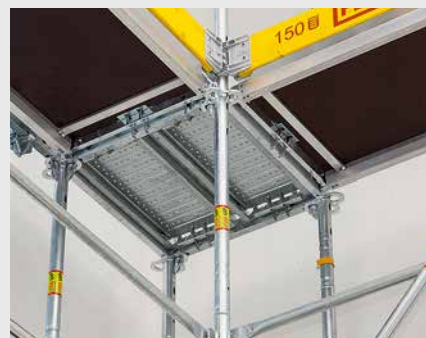
V podlahách PERI UP Easy je integrovaná poistka proti nadvihnutiu. Poistka zapadne pod horizontálu a podlaha sa tým zaistí.
