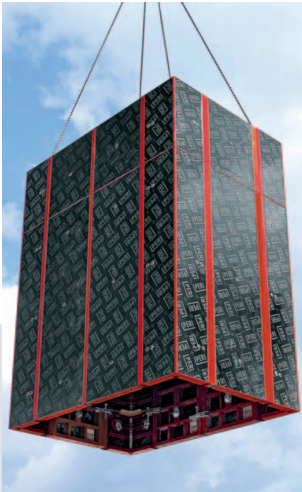
Vnútročné šachtové debnenie s plochou 47,25 m 2 , výškou 4,50 m a pôdorysnými rozmermi 3,05 x 2,20 m – premiestňované naraz.
